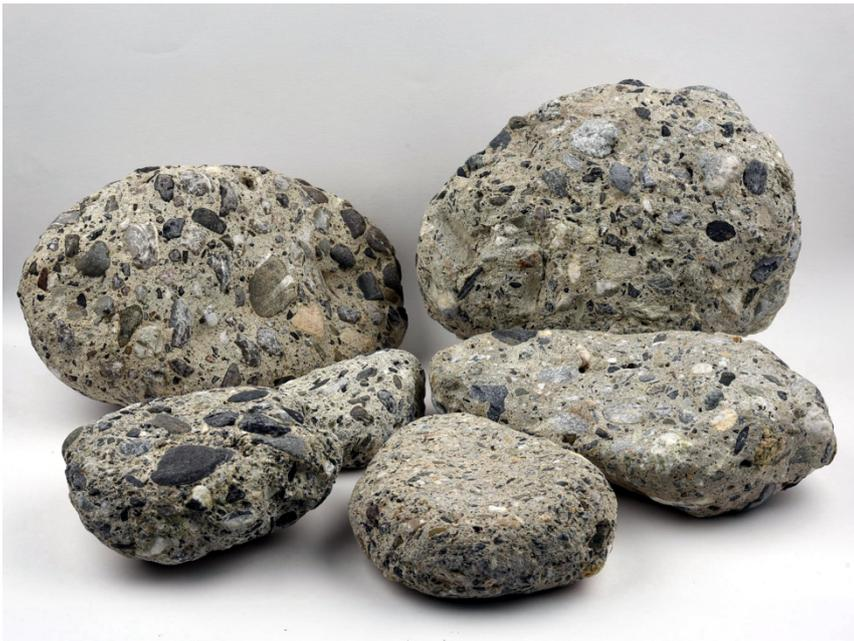
Figure 3 : Galets de béton provenant de la rivière de l'Avançon (commune de Bex, Vaud) considérés comme technofossiles.
